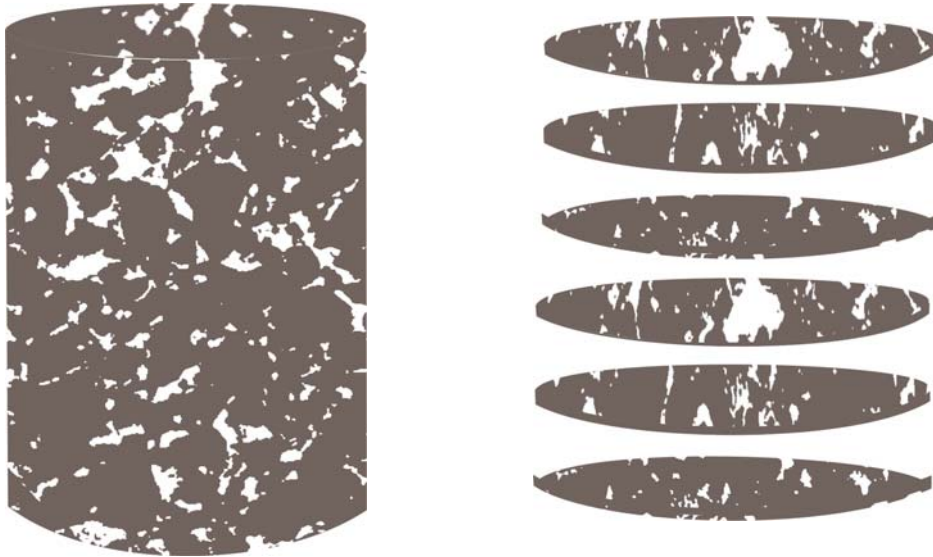
Figura 1. Amostra de material poroso: microestrutura estatisticamente homogênea e isotrópica
